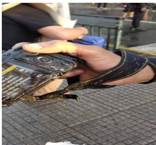
Foto 1 cámara fotográfica inutilizada por elementos químicos del agua
